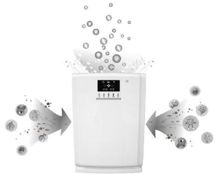
净化效果用净化器的洁净空气量 (CADR) 表示。CADR 低于或接近于卫生要求的房屋空气自然交换率 (每人每小时新风量 30 立方米) 的空气净化器不具有实际使用价值。CADR 最好大于每小时 90 立方米。
